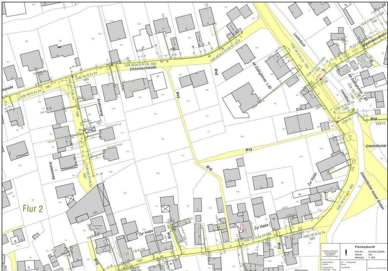
Abb. 8: Vorhandene Gasleitungen der Rhein-Sieg-Netz-GmbH
